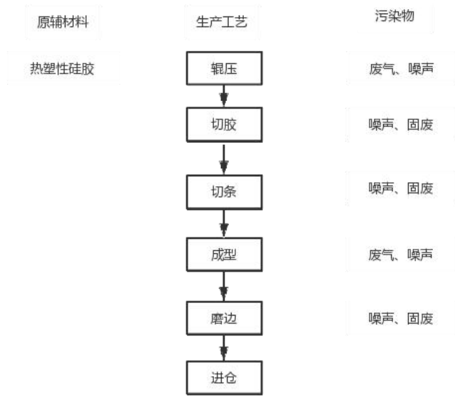
图 4 本项目橡胶制品生产工艺及产污环节示意图
