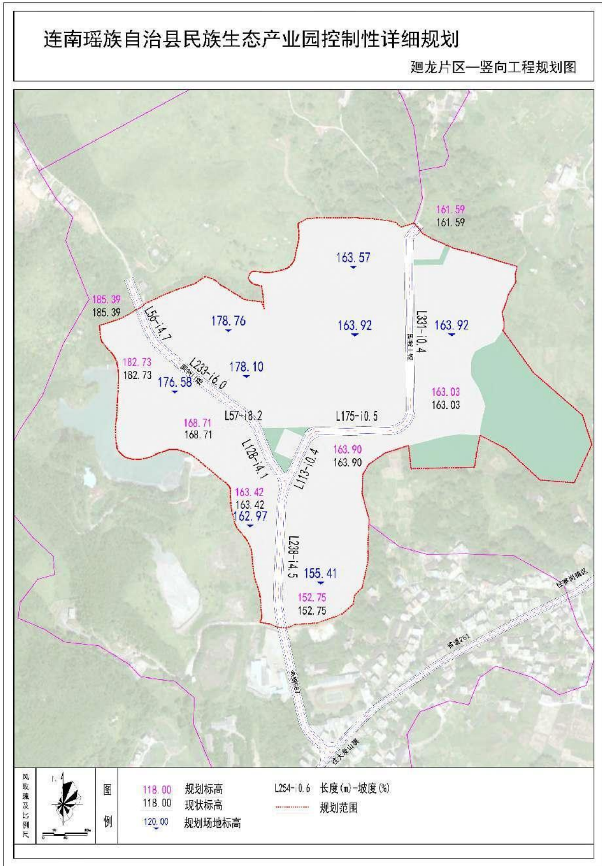
图 1-18 廻龙片区竖向工程（标高）规划图（资料来源：控规）
